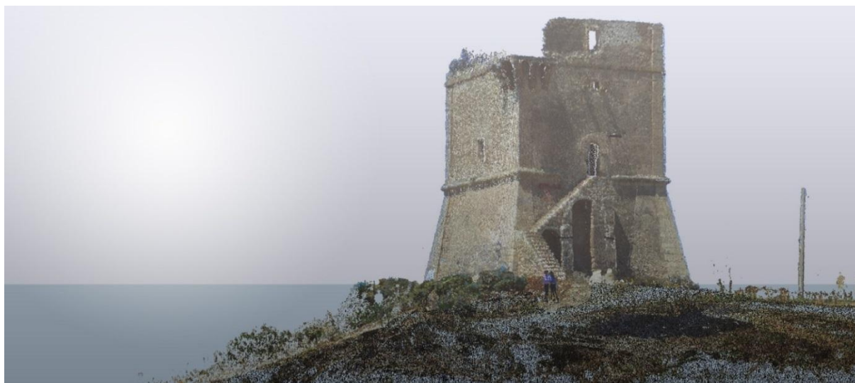
Fig. 8 - La 'Torre di Manfria': la nuvola di punti del rilievo 3D laser scanning.
