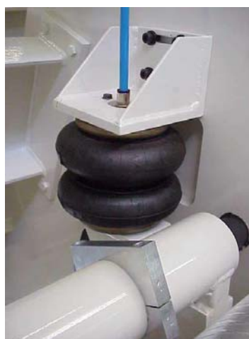
Figura 3.11 - Attuatore pneumatico a doppio soffiETTO (modello Mecman 192-216-100)
