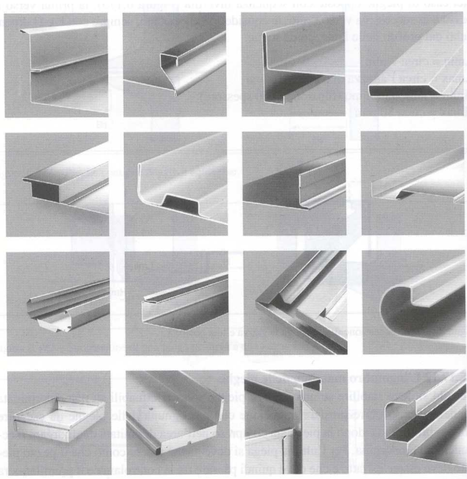
Figura 18: Esempi di pieghe e prodotti ottenibili per pannellatura.
