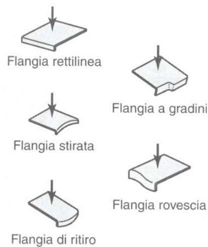
Figura 14: Esempi di lamiere flangiate.
