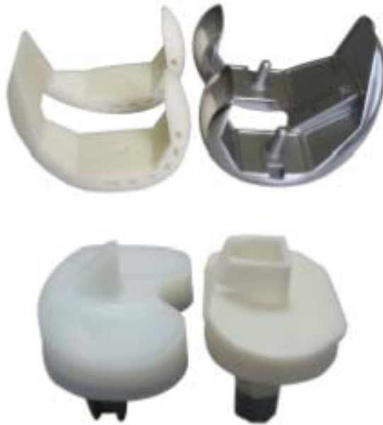
figura 1: modello della protesi ZIMMER NexGen® Legacy® Knee LPS-Flex prosthesis) realizzato tramite prototipazione rapida .
