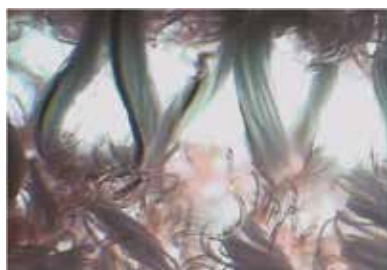
Dettaglio dei fili in rame e zinco
