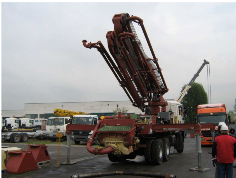
Figura 31: Pompa autocarrata utilizzata per le prove di pompaggio del conglomerato
