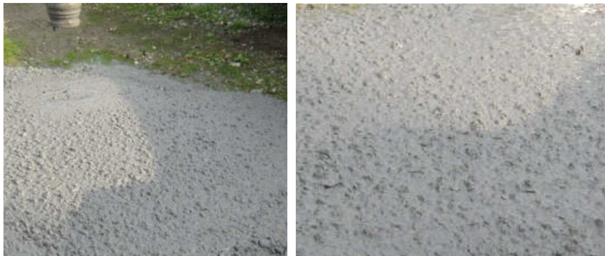
Figura 44: Aspetto del conglomerato dopo prova di pompabilità
