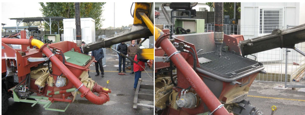
Figura 32: Configurazione per prova di pompaggio del conglomerato.
