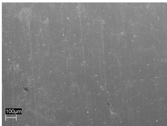
Figura 64: aspetto della superficie laterale di un provino cilindrico di acciaio al carbonio (S235JR) sottoposto a prova alla velocità di rotazione di 3000 rpm
