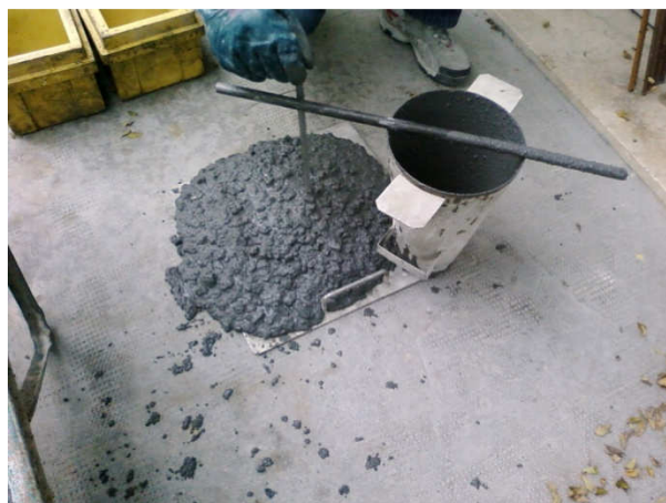
Figura 41: Slump test condotto sull'impasto prelevato a bocca di betoniera
