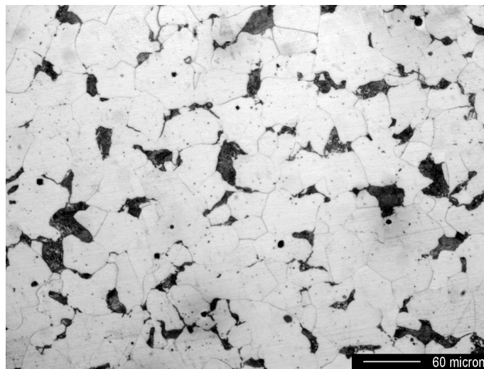
Figura 33: Microstruttura dell'acciaio S235JR al carbonio considerato per la sperimentazione (attacco Nital 2%)
