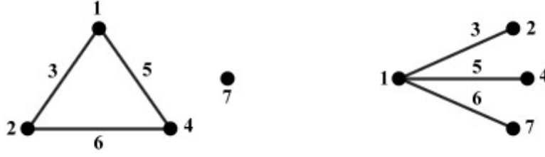
Figura 3.13: Diagramma lineare dell'array di Taguchi L_8 (2^7) .
