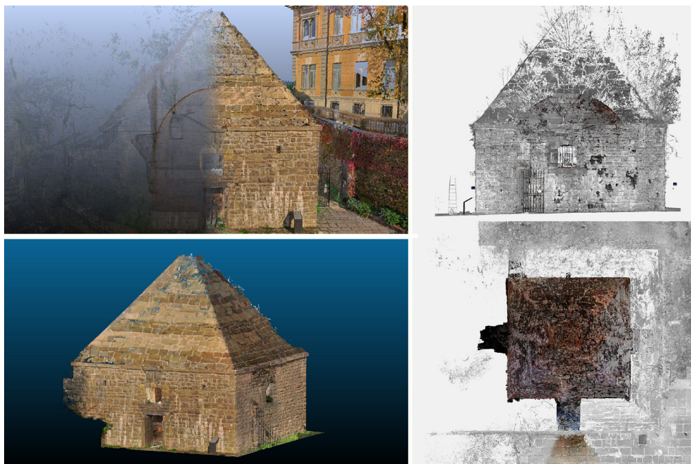
Fig. 6a- Il rilievo del torresino: elaborazione del modello RGB e proiezioni ortografiche (Lab_S.A.B.E.)
