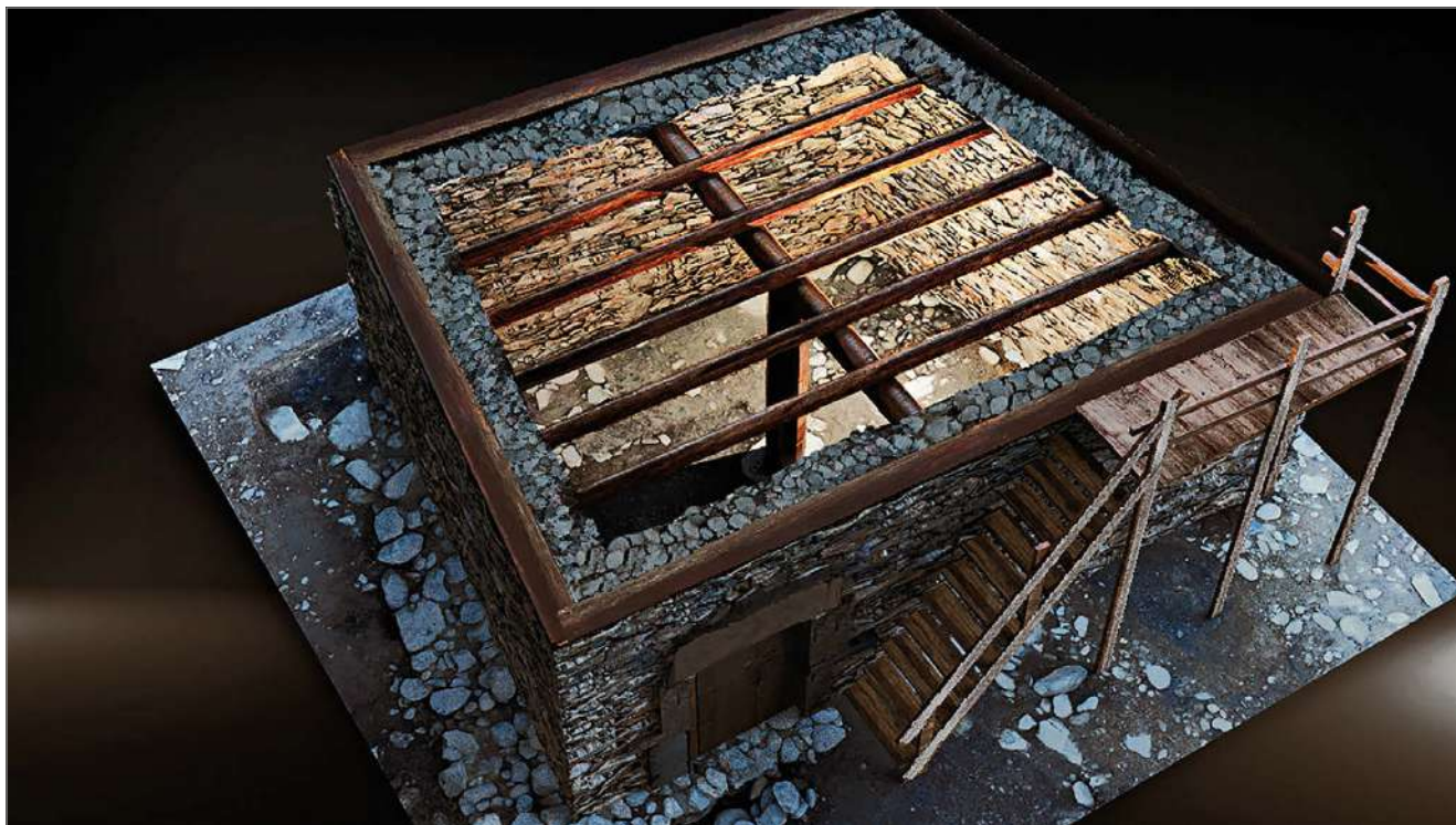
fig. 13 – Ricostruzione virtuale dell'ordito ligneo interno della casa di XI secolo di Piuro (immagine elaborata da F. Sala).
