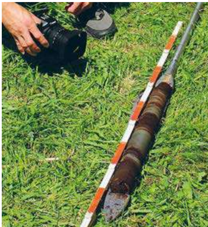
Figura 18. Operazioni di carotaggio: il segmento di carota 40-90 cm, appena estratto con un carotiere da torbe al Pantanaccio di Santa Elisabetta, mostra le intercalazioni di limi grigi di Età Romana e medievale dell'archivio di torbiera (foto Cesare Ravazzi, 9 luglio 2021).
