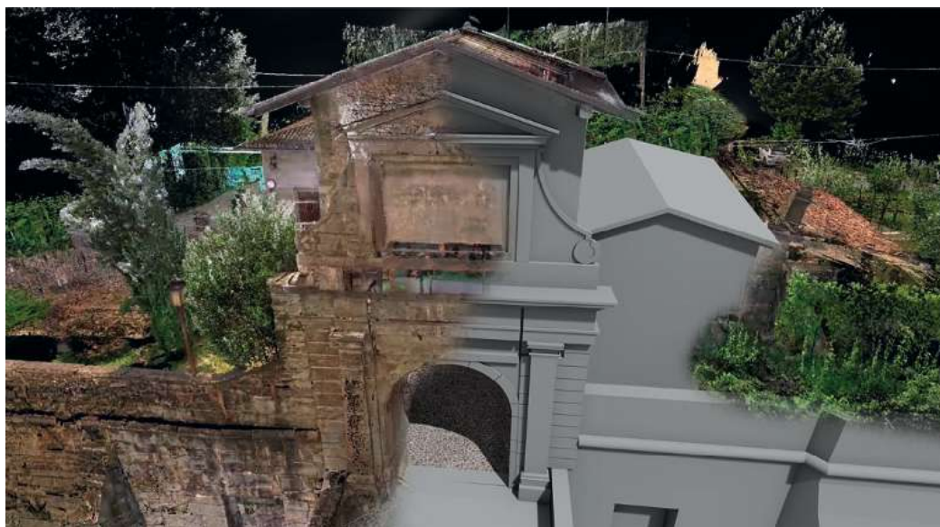
Fig. 9a. Rilievo 3D e modello Scan-to-BIM della Porta di San Lorenzo: confronto tra dato acquisito, forma interpretata e ricostruzione parametrica (S.A.B.E. 2025).
