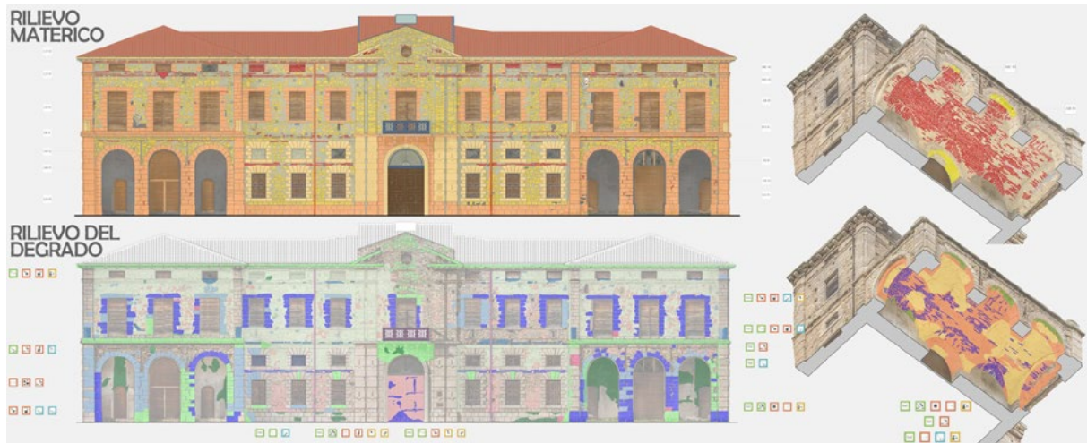
Fig. 3. Restituzione grafica del rilievo: elaborati di caratterizzazione materica e del degrado.
