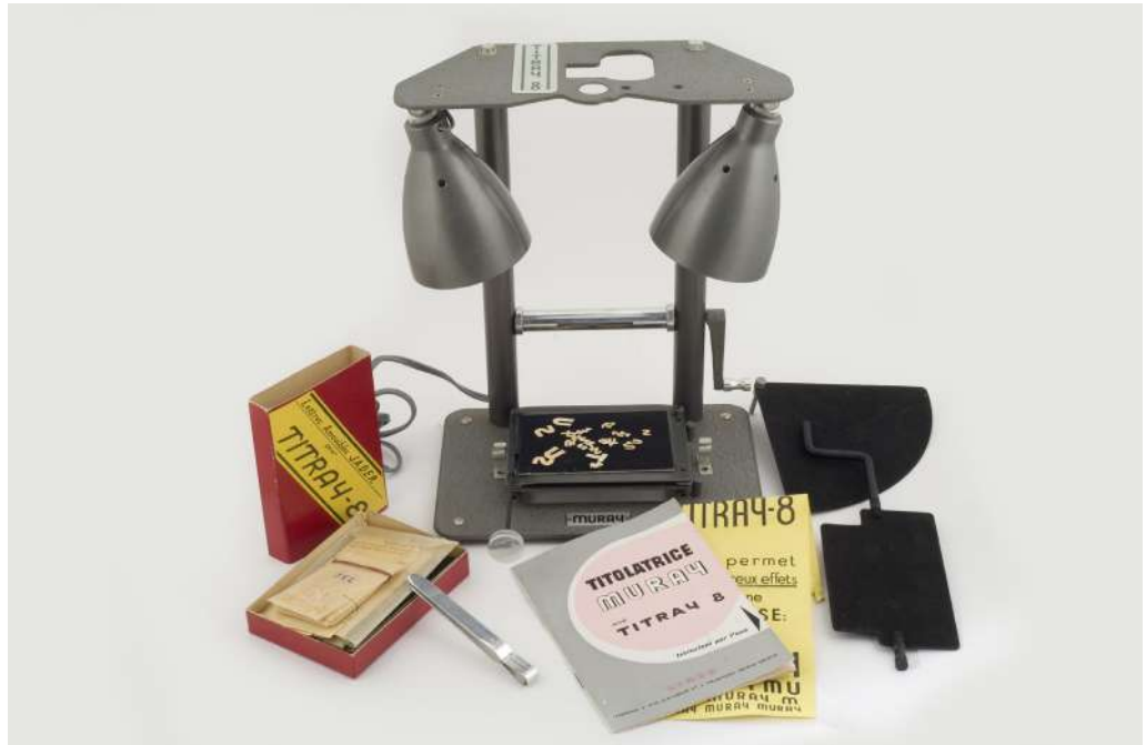
Fig 3a – Titolatrice per pellicole 8mm Muray, modello "Titray 8", con accessori ed esempi di cartelli, seconda metà del XX secolo (inv. IGB-10737), donazione B. e R. Invernizzi, Museo Nazionale Scienza e Tecnologia Leonardo da Vinci, Milano (© Moira Ricci | Museo Nazionale Scienza e Tecnologia Leonardo da Vinci, Milano).
