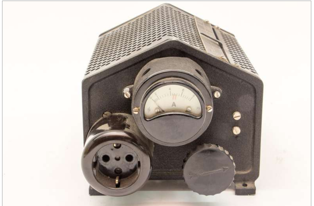
Fig 1 – Resistenza per proiettore, seconda metà del XX secolo (inv. IGB-16635), donazione M. Pedone, Museo Nazionale Scienza e Tecnologia Leonardo da Vinci, Milano (© Museo Nazionale Scienza e Tecnologia Leonardo da Vinci, Milano).
