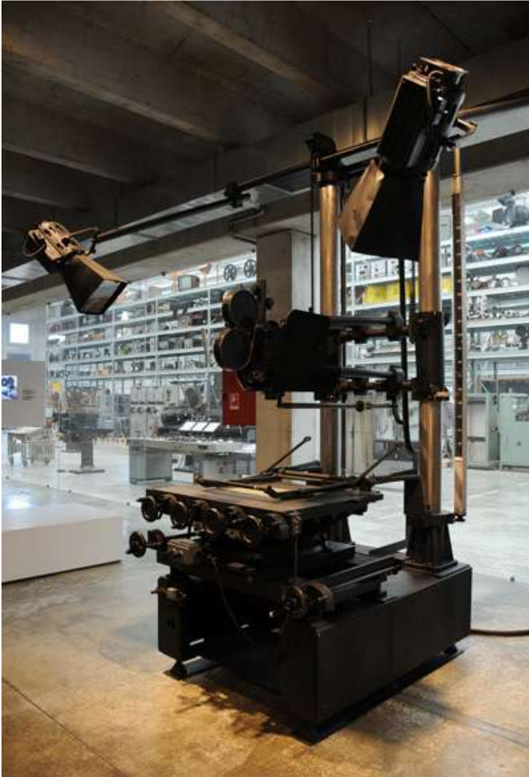
Fig. 2 – Il banco per animazioni o titolatrice a 16mm e 35mm con truka ottica del fondo Roberto Gavioli, esposto presso la Fabbrica del cinema del MUSIL a Rodengo Saiano. Per gentile concessione della Fondazione Luigi Micheletti.
