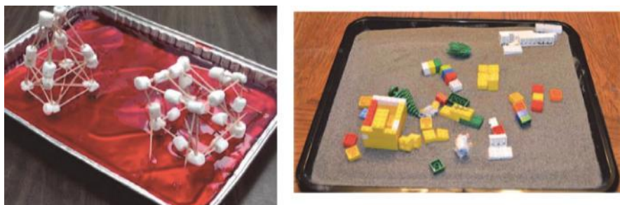
Fig. 10 - Altri esempi di shake table : una teglia con uno strato di gelatina oppure un vassoio con la sabbia
