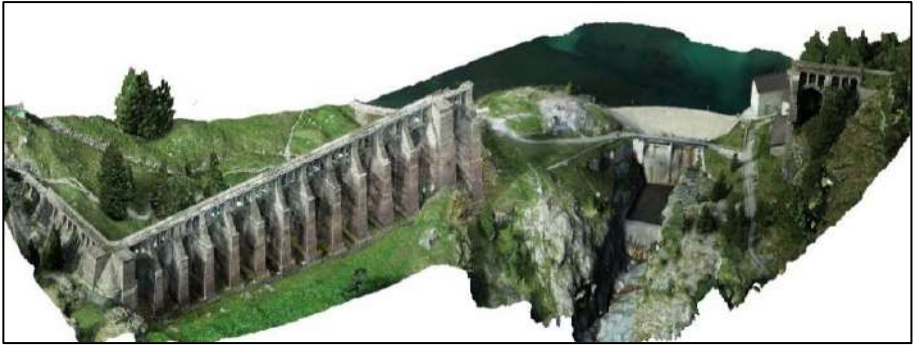
Fig. 3 – Ortofoto 3D realizzata tramite ricostruzione di un modello fotogrammetrico sulla base dei dati acquisiti con Sistema Aereo a Pilotaggio remoto. R. Folli (2023)
