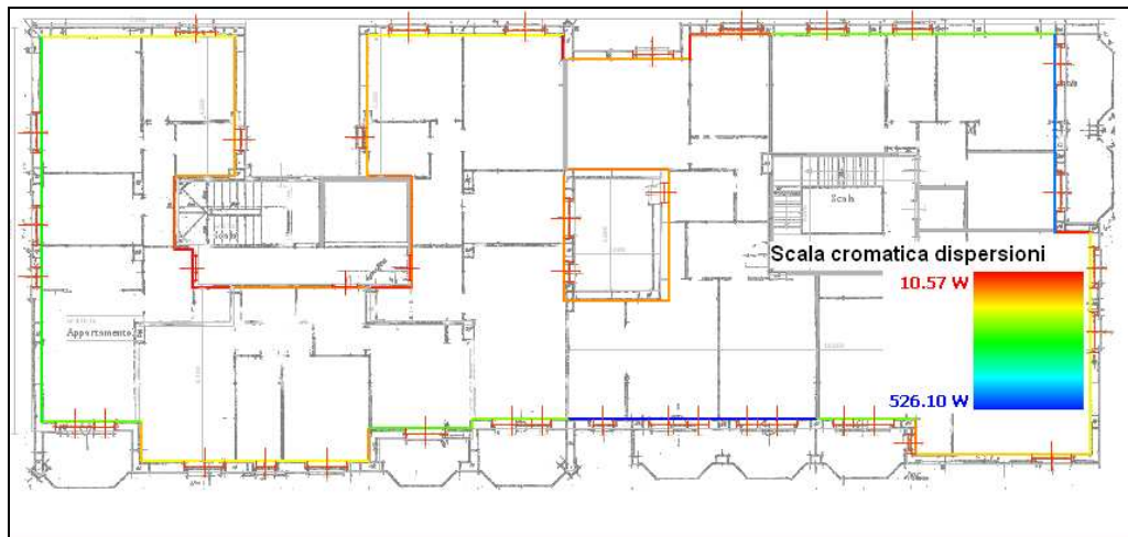
Figura 14. Dispersioni del 3° piano dell'edificio dopo apposizione del cappotto da 8 cm con protezione IR
