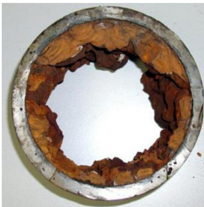
Fig. 93: sezione di una tubazione per trasporto di acqua potabile dismessa dopo decenni di esercizio: aspetto della scaglia costituita dai tubercoli [144]
