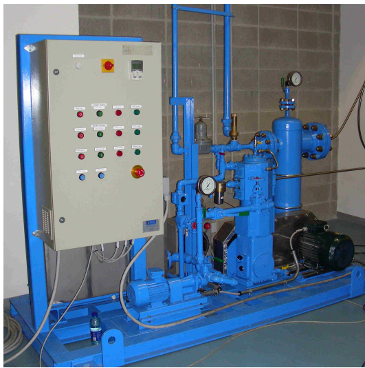
Figura 5.23: Compressore alternativo monostadio utilizzato nell'impianto di test.
