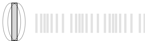
Figura 1.1: Onde di pressione prodotte da una superficie piana vibrante.
