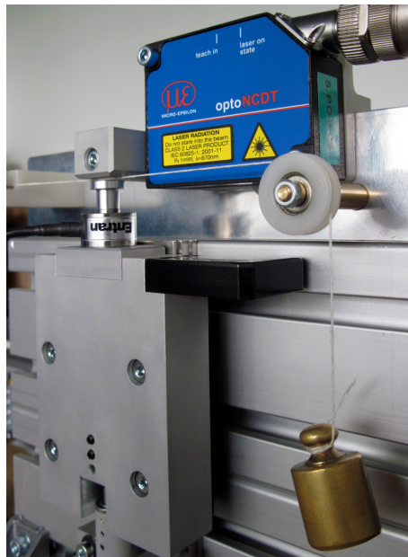
Figura 5.5: Zona di misura con cella di carico e laser
