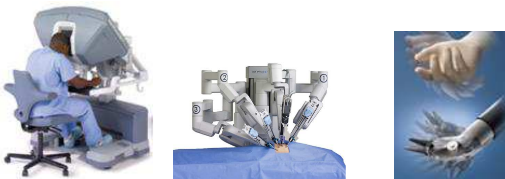
Figura 1.12: Componenti del sistema Da Vinci (da sinistra: console, manipolatore e polso rotante).
