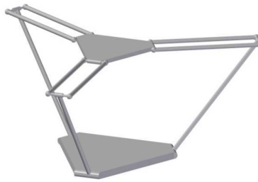
Figura 4.4: Configurazione singolare: tutti i parallelogrammi sono complanari.
