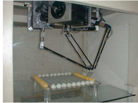
Figura 1.20: Robot Delta 270 sviluppato dal team di lavoro di Clavel.
