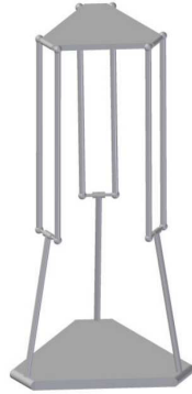
Figura 4.5: Configurazione singolare: tutti i parallelogrammi sono paralleli.
