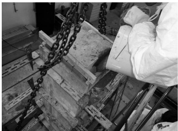
Figura 3 – Getto della camicia in HPFRC
