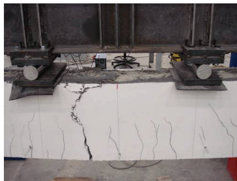
Figura 19 – Distribuzione delle fessure al collasso per la trave B
