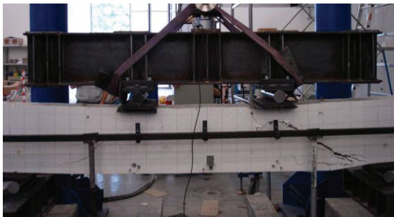
Figura 11 – Fessure al collasso per la trave non rinforzata
