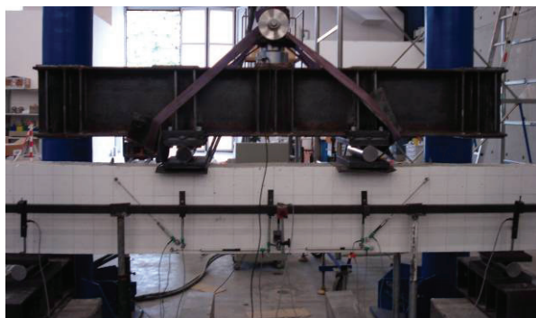
Figura 8 – Strumentazione faccia anteriore della trave
