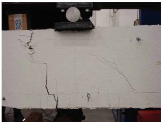
Figura 15 – Distribuzione delle fessure al collasso per la trave E
