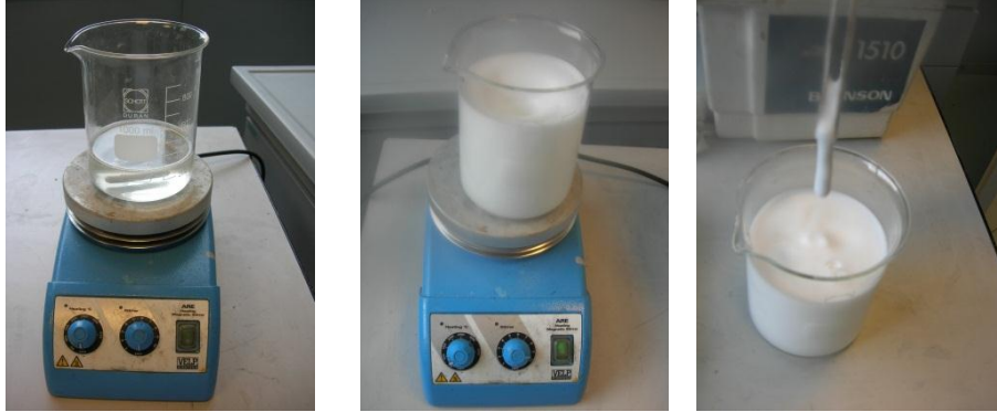
Figura 3-10 – Miscelazione di acqua e LAS mediante agitatore magnetico.
