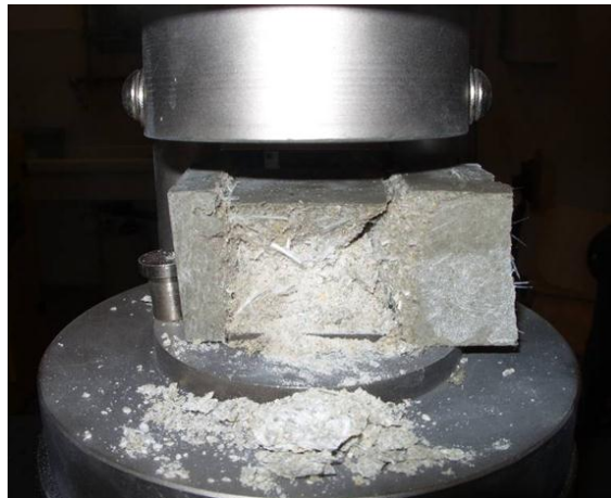
Figura 4-22 – Provino di malta cementizia rinforzato con fibre di vetro dopo rottura a compressione
