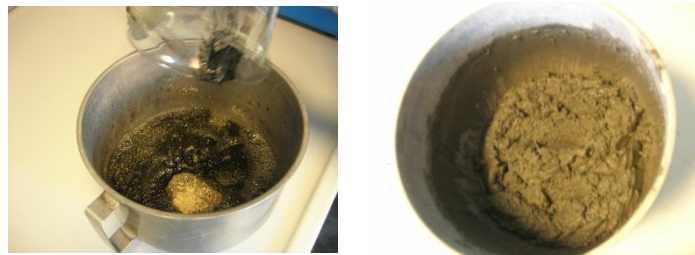
Figura 3-12 – Impasto prima e dopo la miscelazione in maltiera (sopra la pasta cementizia e sotto la malta).
