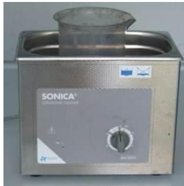
Figura 3-6 – Sonicazione della soluzione composta da \frac{3}{4} dell'acqua d'impasto e i nanotubi in carbonio.
