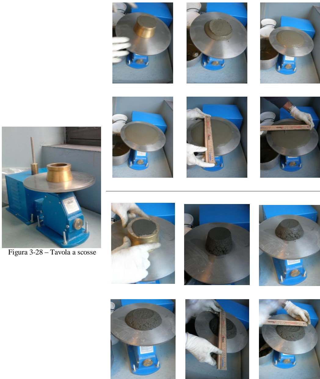
Figura 3-29 – Procedura per la determinazione del diametro di spandimento (sopra: pasta, sotto: malta)
