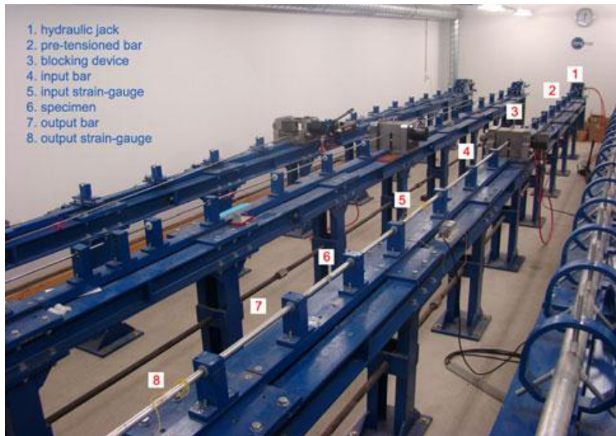
Figura 3-36 - DynaMat Laboratory: set-up for la misurazione della resistenza a trazione ad alte velocità di deformazione
