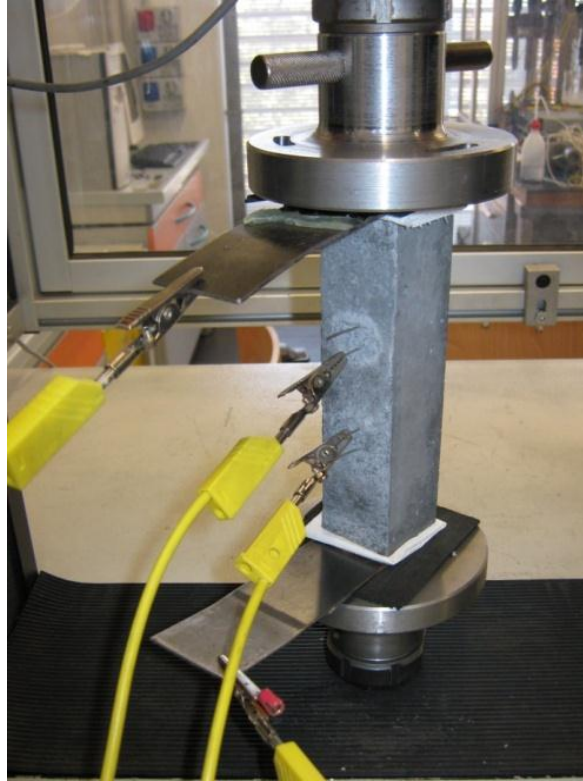
Figura 5-28 – Configurazione provini a quattro elettrodi (due interni + due esterni)
