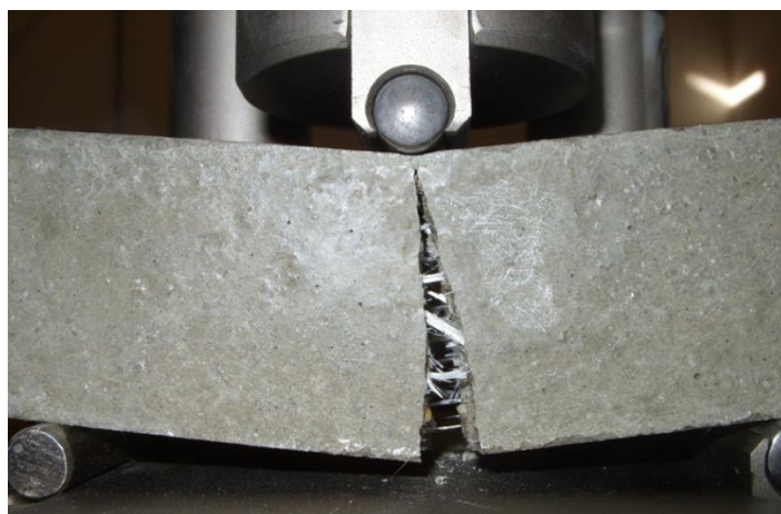
Figura 4-15 – Provino di malta cementizia rinforzato con fibre di vetro dopo rottura a flessione
