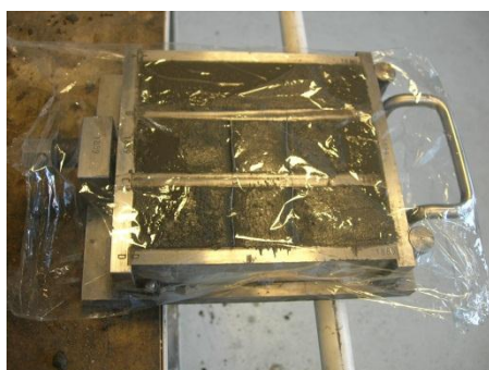
Figura 3-24 – Introduzione degli elettrodi e copertura del cassero (sinistra: 2inox; destra: 4rame)
