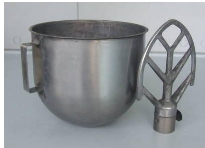
Figura 3-13 – Maltiera conforme alla UNI EN196-1
