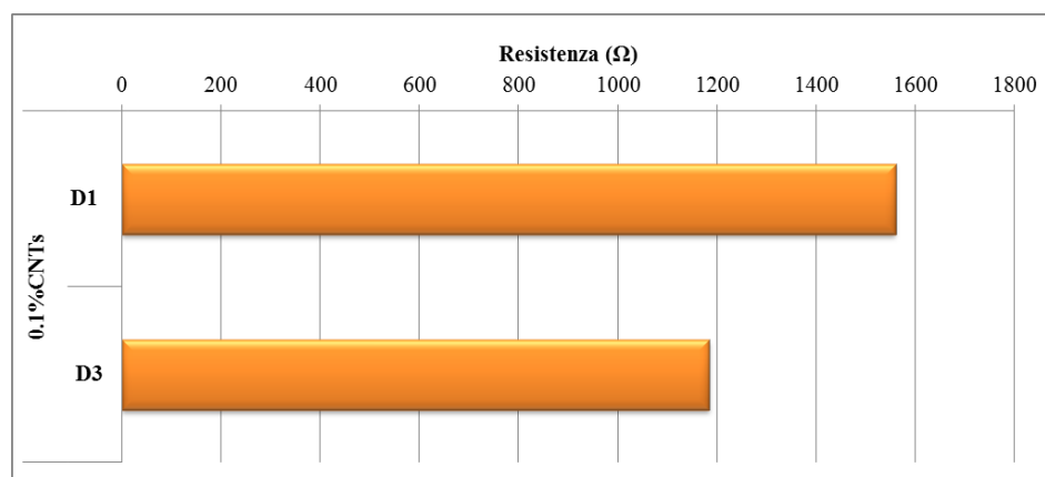
Figura 5-7 – Resistenza elettrica di paste cementizie rinforzate con lo 0.1% CNTs in funzione del metodo di dispersione D1 (sonicazione) e D3 (tensioattivo).
