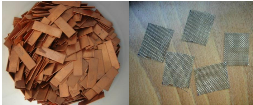
Figura 3-20 – Tipi di elettrodi (a dx. piattine di rame e a sx. retine in inox)
