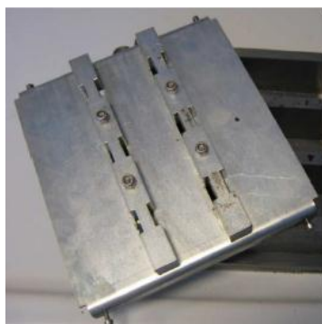
Figura 3-23 – Coperchio in acciaio utilizzato per i provini con configurazione di elettrodi 4 rame.
