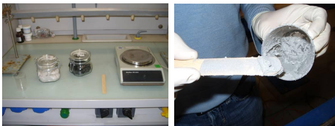
Figura 3-34 – Resina epossidica: due componenti (sx), miscela finale (dx).
