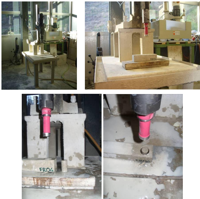
Figura 3-33 – Carotatrice (in alto a dx) e operazioni di carotaggio dei provini.
