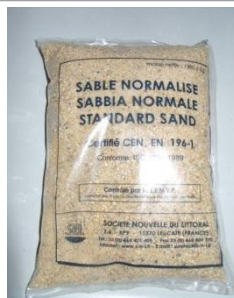
Figura 3-2 – Sabbia Standardizzata (sinistra) e dettaglio (destra).
