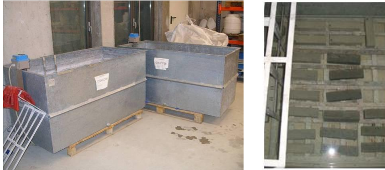
Figura 3-25 – Vasca di maturazione e provini al suo interno durante la maturazione umida.
