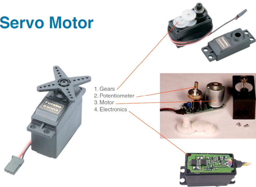
Figura 40: Composizione di un servomotore
