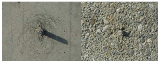
Figura 2. Campione RCJ1 prima e dopo la sabbiatura
