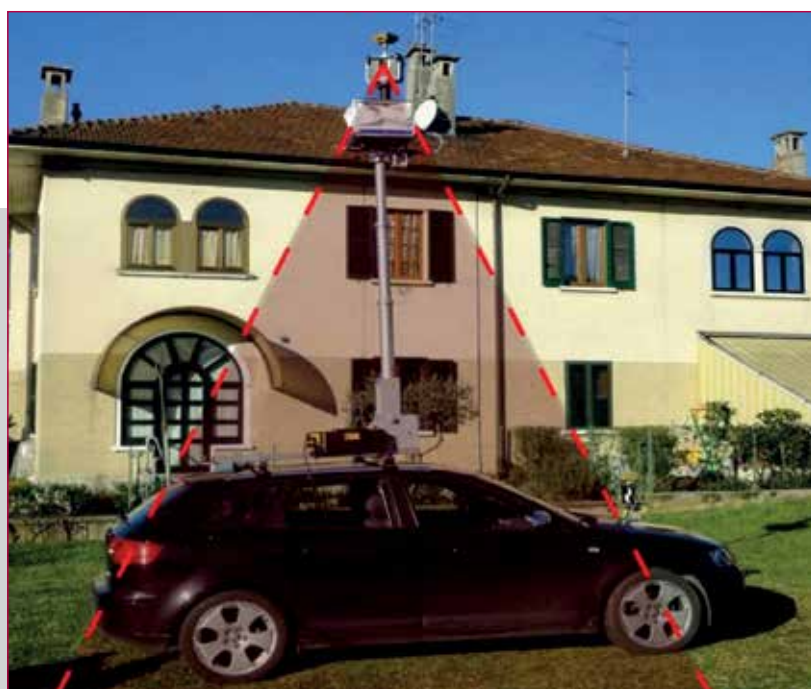
Fig. 4a - Cono di esclusione del laser durante la scansione.
