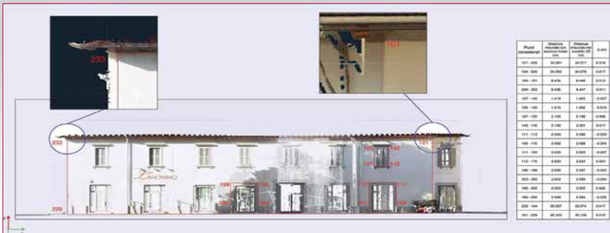
Fig. 12 - Vista ortografica di un edificio verificato, con le distanze di controllo e gli scarti.
