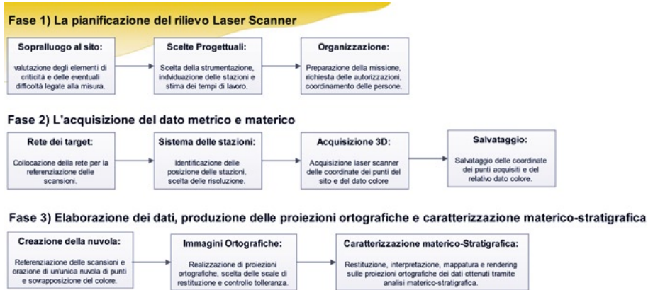
Fig. 6 – Workflow delle fasi di lavoro: dalla pianificazione del rilievo laser 3D scanning alla produzione delle analisi materico-stratigrafica di elaborati in scala.
