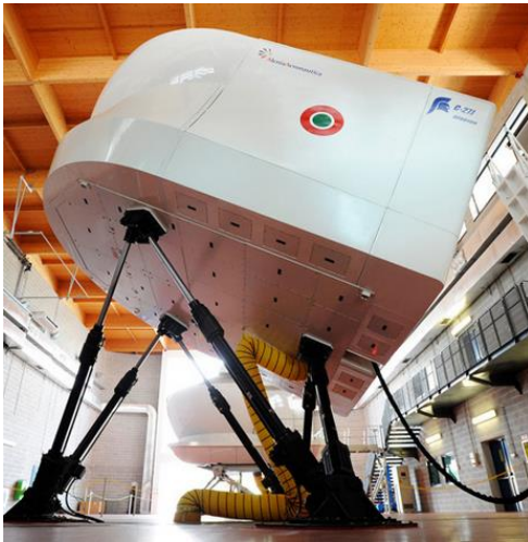
Figura 1.2: Dispositivo di simulazione di volo "C-27J AM Full Flight Simulator"
