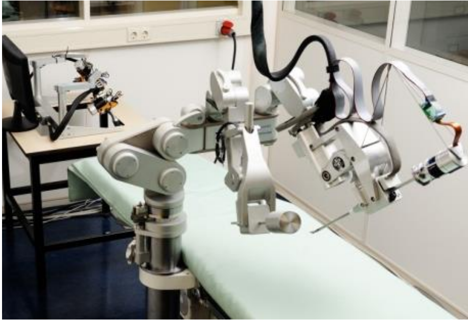
Figura 1.6: Dispositivo di telechirurgia “Sofie (Surgeon’s Operating Force-feedback Interface Eindhoven)”
