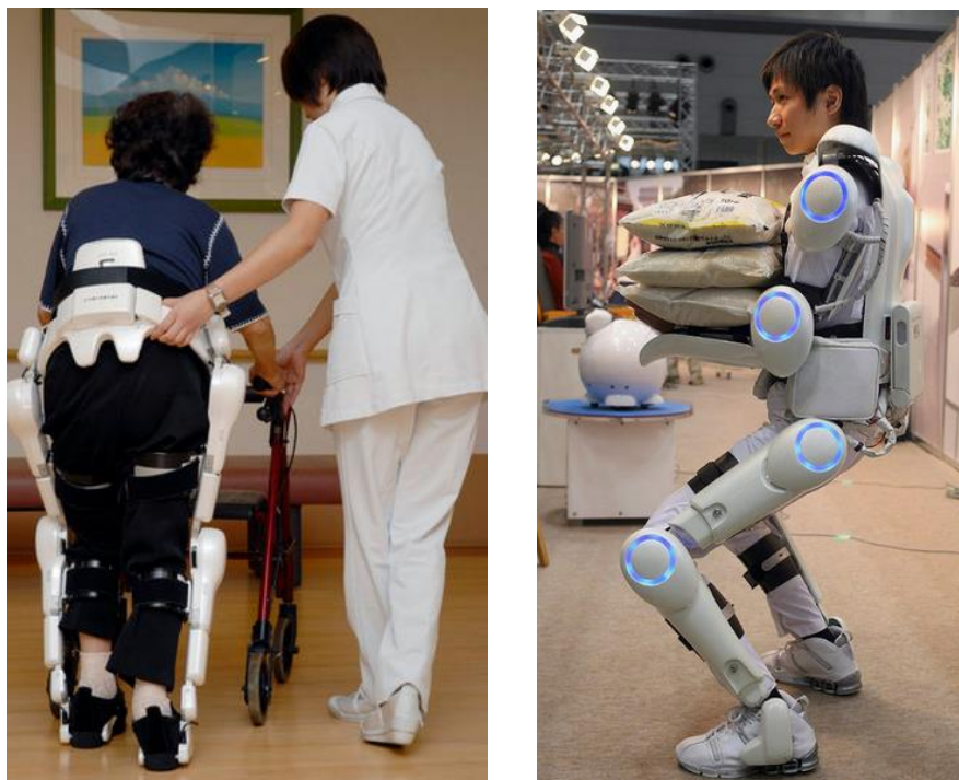
Figura 1.8: Dispositivo per la riabilitazione "Robot Suit HAL"
