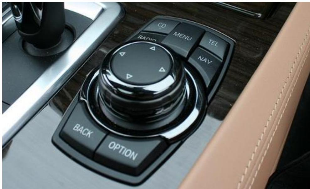
Figura 1.9: Manopola aptica 1gdl montata su BMW "iDrive" [34]
