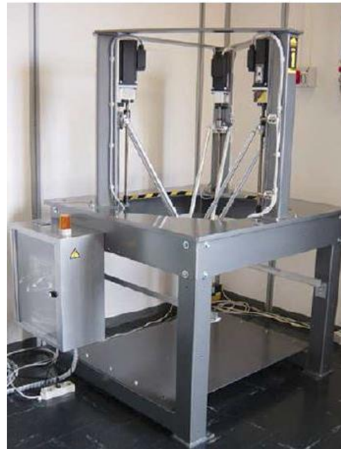
Figura 12.2: Manipolatore "S.L.O.T.H." – robot slave
