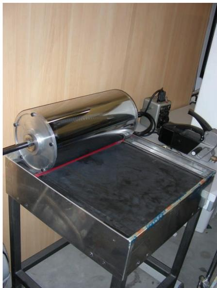
*Figura 3.1* Piano per la stesura degli elettrodi
