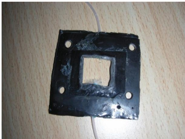
*Figura 5.18* Separatore degli elettrodi in cui circola l'elettrolita
