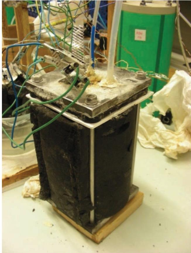
*Figura 5.36* Cella Evo1 avvolta con materiale coibentante
