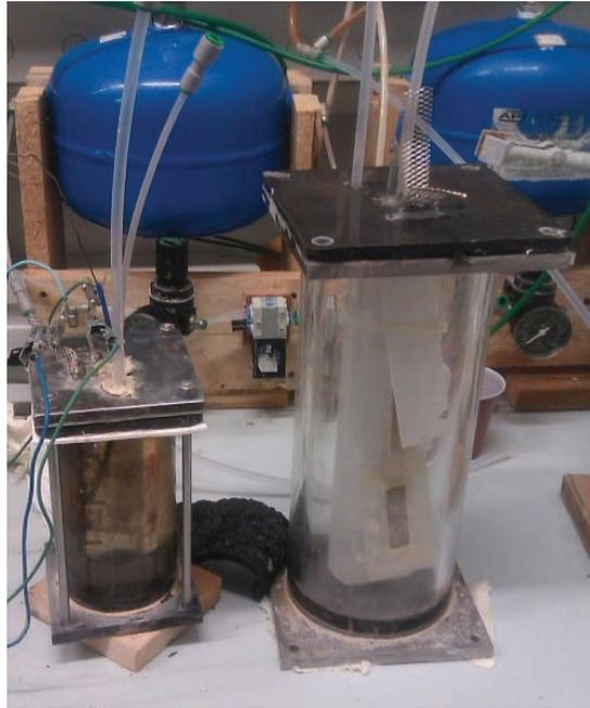
Figura 5.59 Cella Evo2 (sulla destra) realizzata scalando la cella Evo1
