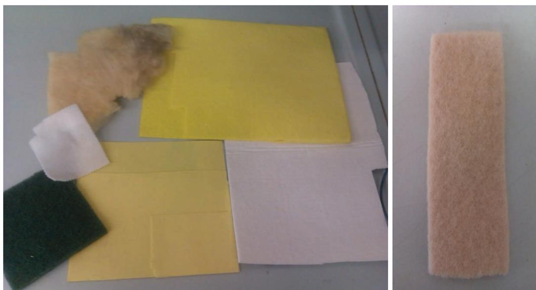
*Figura 5.3* Serie di composti spugnosi testati per il comparto elettrolita
