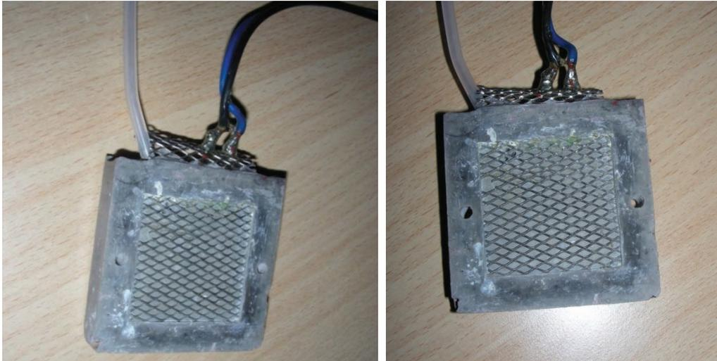
*Figura 5.17* Cuore centrale della cella di resina su cui vengono posti gli elettrodi
