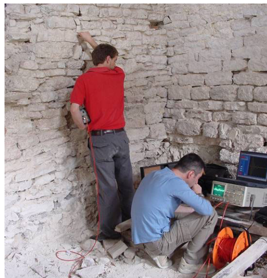
Figura 5. Mappatura delle velocità soniche rilevate su un pannello campione ed esecuzione delle prove con l'attrezzatura impiegata.
