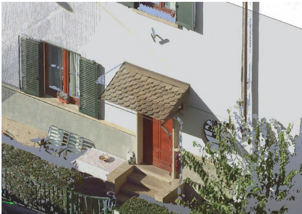
Figura 7c Modello 3D (rilievo statico) di un edificio, con texture fotografiche
