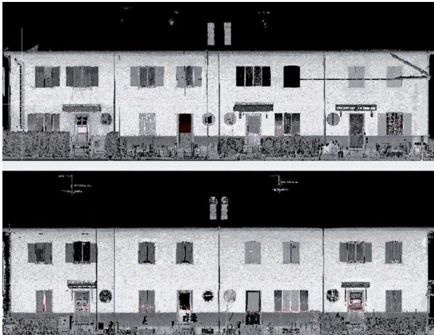
Figura 7a Vista ortografica di elementi delle cortine edilizie, con valori di riflettanza (rilievo cinematico)
