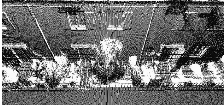
Figura 7b Modello 3D (rilievo cinematico) di un edificio con valori di riflettanza
