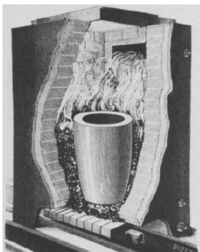
Figura 66. "Nouveau fourneau à creuset", «La Nature», 1883.
