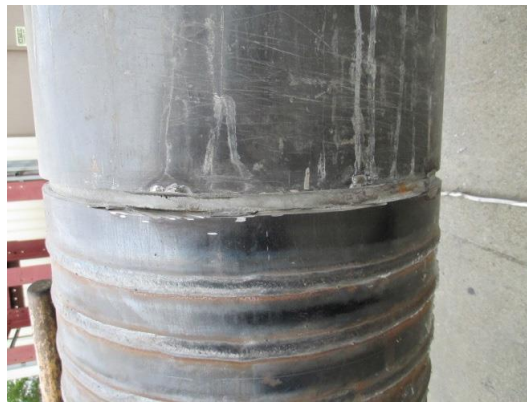
Figura 145. Rimozione di uno strato del tubo in acciaio (Blind prediction contest, 2017). / Removal of shell strip (Blind prediction contest, 2017).
