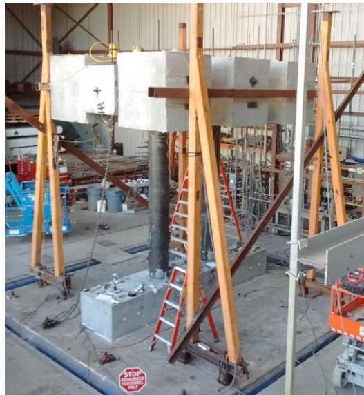
Figura 141. Colonne resilienti testate su tavola vibrante presso il laboratorio dell'Università della California a Berkeley (Blind prediction contest, 2017). / Self-centering resilient columns tested on the PEER UC Berkeley shaking table (Blind prediction contest, 2017).
