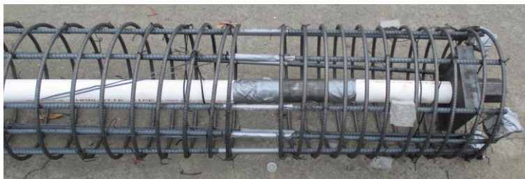
Figura 143. Zone di interfaccia non aderenti ( Blind prediction contest, 2017 ). / Mild steel debonding detail (Blind prediction contest, 2017) .
