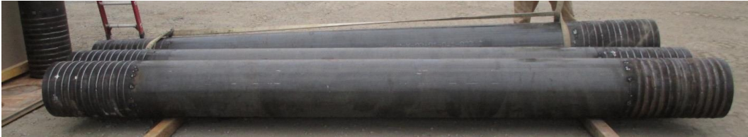
Figura 142. Tubi esterni in acciaio delle colonne ( Blind prediction contest, 2017 ). / Column steel shells (Blind prediction contest, 2017) .
