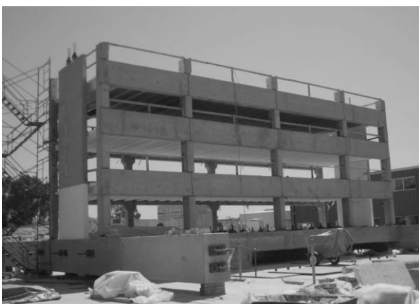
Figura 22. Presentazione del caso studio di tipo prefabbricato (Belleri et al., 2013) e impostazione della prova sperimentale su tavola vibrante (Belleri et al., 2014). / Half-scale, three-story, precast concrete structure tested at UCSD (Belleri et al., 2013) and shake table test setup (Belleri et al., 2014).
