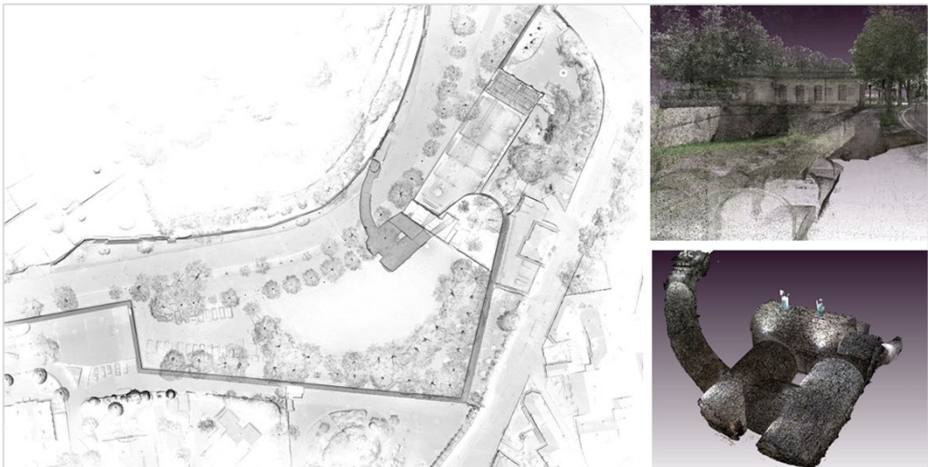
Fig. 4- Il rilievo della tenaglia di Sant'Agostino con la porta e la cannoniera (elaborazione e restituzione grafica di S.A.B.E.).
